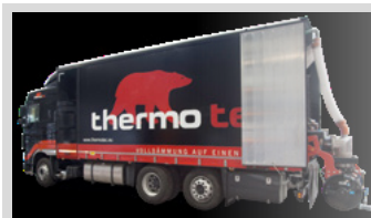
Isporuka, miješanje i pumpanje obavlja thermotec Mixmobil
