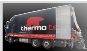
Isporuka, miješanje i pumpanje obavlja thermotec Mixmobil
